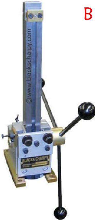
La brocciatrice manuale **CNB-35** è stata progettata e realizzata per coadiuvare i laboratori di prova e di controllo qualità nella preparazione dei provini per le prove di resilienza.
